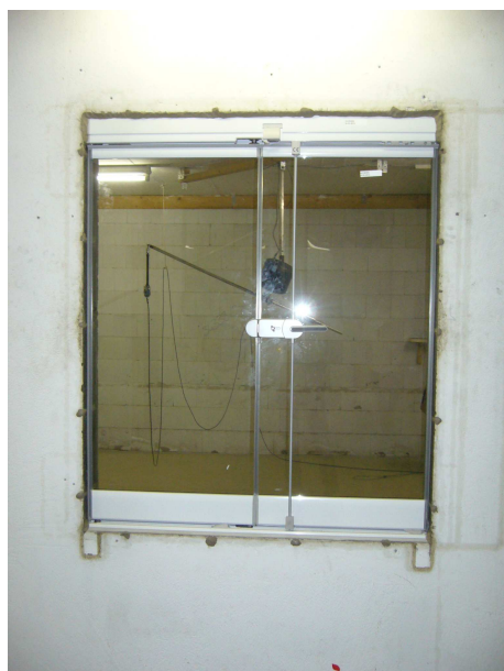
Bild 1 Foto des eingebauten Elementes, erstellt vom ift Labor Bauakustik
