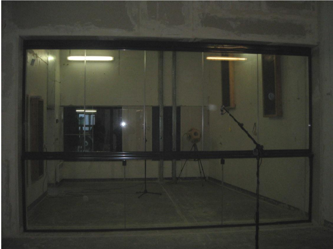
Bild 1: Balkonverglasung Lumon 5 mit Lumon Glas-Brüstung, Ansicht Senderaum (Außenseite)
